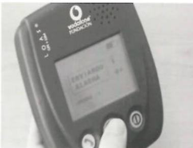
Prototipo del Proyecto LOAS: Sistema de localización y alarma, basado en la tecnología GPS y GSM para discapacitados y personas mayores.
